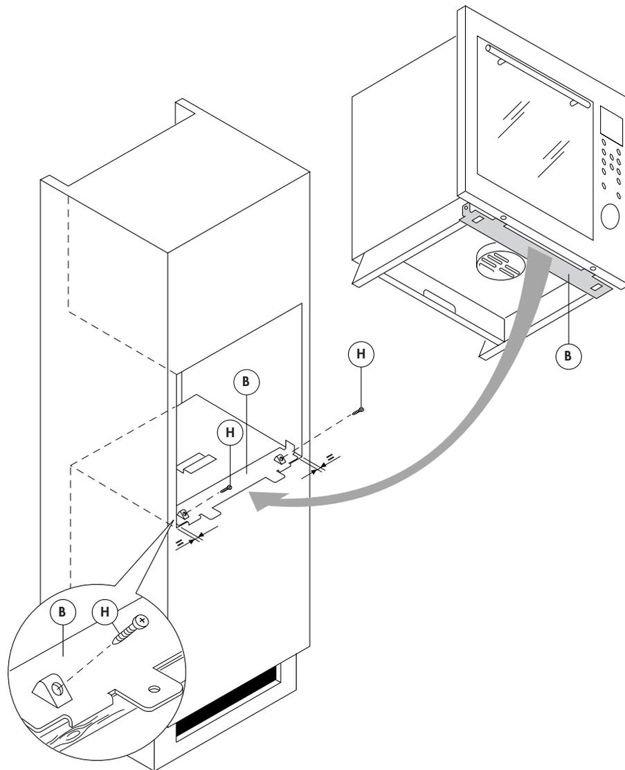
Montieren Sie das Befestigungsprofil so, dass die beiden Lippen über den Rand des Nischenbodens ragen und vorne bündig ist.
