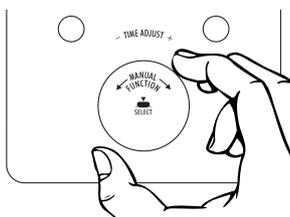
1. Den Drehknopf **SELECT 'MANUAL FUNCTION'** (10) drehen, bis auf der ersten Zeile des Displays die Anzeige „GRILL“ erscheint.
