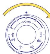
**3** Drehen Sie den oberen Drehknopf auf die gewünschte Zeit. Die **Kontrollampe Grill** schaltet ein.
