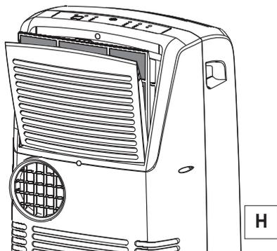
Benutzen Sie zur Entfernung des auf dem Filter abgelagerten Staubs den Staubsauger. Sollte der Filter sehr schmutzig sein, waschen Sie ihn in lauwarmem Wasser und spülen ihn dann mehrmals nach.
