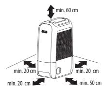
Stellen Sie das Gerät im Raum, der entfeuchtet werden soll, auf. Bitte halten Sie die Mindestabstände zu den Möbeln und den Wänden, wie in der Abbildung angegeben, ein.
