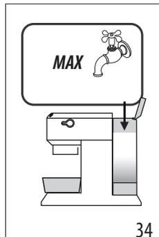
8. Die Kaffeemaschine ist für den Spülvorgang mit frischem und sauberem Wasser bereit. Den Wassertank entnehmen, leeren, mit fließendem Wasser ausspülen, bis zum Füllstand MAX mit frischem Wasser füllen (Abb. 34) und wieder in die Kaffeemaschine einsetzen.
