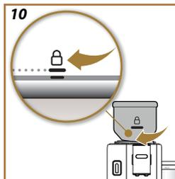
13. Setze den Bohnenbehälter ein und drehe ihn im Uhrzeigersinn, damit er einrastet. Um ihn richtig einzusetzen, muss das Symbol ☐ auf die Markierung am unteren Ring ausgerichtet sein (Abb. 9) und muss der Behälter nach dem Einsetzen auf die Position ☐ gedreht werden (Abb. 10). Drücke „Weiter“.
