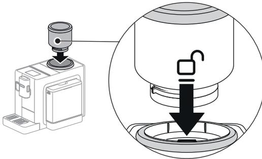
*Drehe den Bohnenbehälter im Uhrzeigersinn, bis die Verriegelungsstellung
