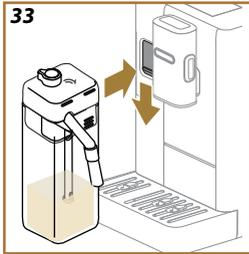
4. Schiebe die Klappe nach unten, drücke die Karaffe fest auf den Anschluss und raste sie daran ein (Abb. 33). Es ertönt ein akustisches Signal (falls die Funktion eingeschaltet ist);
