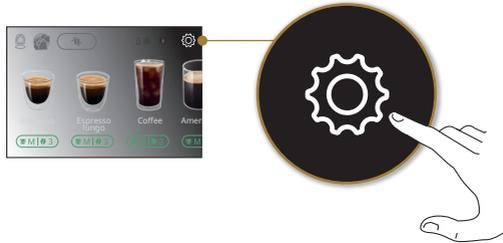
*Blättere durch die Seiten, bis die Option „Spülvorgang“ angezeigt wird und drücke „Ja“, um mit der Ausgabe zu beginnen: nach einigen Sekunden tritt Heißwasser aus, das den internen Kreislauf des Kaffeevollautomaten reinigt und aufheizt.*
