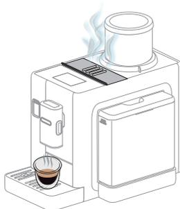
*Es handelt sich um Dampf, der von der verwendeten Kaffeemenge freigesetzt wird, die automatisch im Kaffeesatzbehälter des Kaffeevollautomaten entsorgt wird. Dies gehört zum normalen Betrieb des Kaffeevollautomaten.*
