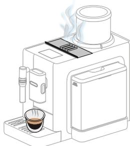
*Es handelt sich um Dampf, der von der verwendeten Kaffeemenge freigesetzt wird, die automatisch im Kaffeesatzbehälter des Kaffeefullautomaten entsorgt wird. Dies gehört zum normalen Betrieb des Kaffeefullautomaten.*
