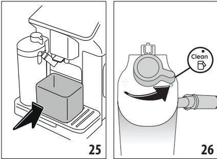
3. Drehe den Drehknopf für Milchschaum/Reinigung (E3) auf „Clean“ (Abb. 26): aus dem Milchauslauf fließen Heißwasser und Dampf. Die Reinigung wird automatisch beendet;
