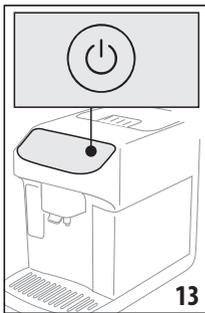
2. Nach Beendigung des Aufheizvorgangs beginnt ein Spülvorgang mit Heißwasser, das aus dem Kaffeeauslauf (A16) fließt; auf diese Weise wird nicht nur der Kessel aufgeheizt, sondern das Gerät lässt heißes Wasser durch die internen Leitungen fließen, damit auch diese sich erwärmen.
