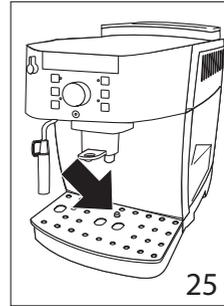
Die Abtropfschale leeren und reinigen, bevor diese Anzeige aus dem Tassenrost hervortritt.
