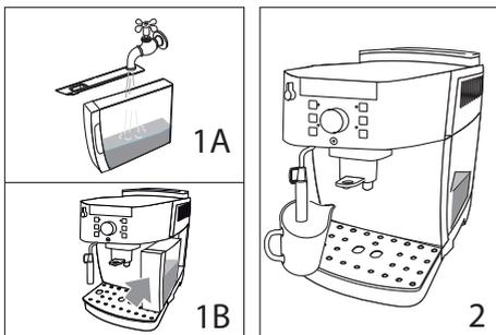
2. Einen Behälter mit einem Mindestfassungsvermögen von 100 ml unter dem Milchaufschäumer «A18» positionieren «Abb. 2».
