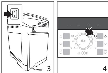
5. An der Bedienblende blinkt die Kontrolllampe «B7» «Abb. 4».
