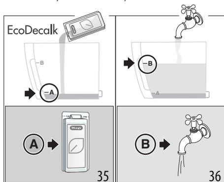
4. Den Entkalker «C2» in den Wassertank füllen, bis der auf der Innenseite des Tanks aufgedruckte Füllstand **A** erreicht ist «Abb. 35» (entspricht einer 100ml-Packung); dann bis zum Füllstand **B** «Abb. 36» mit Wasser auffüllen (ein Liter) und den Wassertank wieder in die Kaffeemaschine einsetzen.
