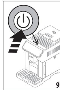
2. Nach Beendigung des Aufheizvorgangs beginnt ein Spülvorgang mit Heißwasser, das aus dem Kaffeeauslauf (A7); fließt; auf diese Weise wird nicht nur das Heizsystem aufgeheizt, sondern das Gerät lässt heißes Wasser durch die internen Leitungen fließen, damit auch diese sich erwärmen.
