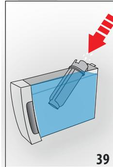
8. „FILTER IN DIE VORRICHTUNG EINSETZEN“: Den Filter (D7) in seine Aufnahme setzen (Abb. 36) und fest nach unten drücken.
