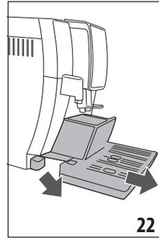
2. Den Kaffeesatzbehälter (A11) leeren und sorgfältig reinigen, dabei darauf achten, dass alle Rückstände entfernt werden, die sich am Boden angesammelt haben: der mitgelieferte Pinsel (D5) verfügt über einen hierfür geeigneten Schaber.
