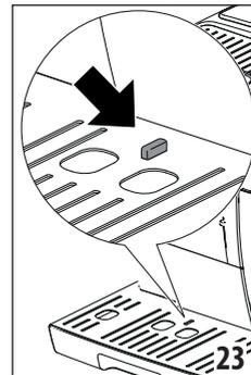
Bevor diese Anzeige aus dem Tassenrost (A12) hervorragt, muss die Abtropfschale entleert und gereinigt werden, andernfalls kann das Wasser über den Rand treten und die Kaffeemaschine, die Aufstellfläche oder den umliegenden Bereich beschädigen. Um die Abtropfschale zu entnehmen, wie folgt vorgehen:
