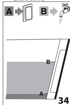
7. "Entkalker und Wasser in den Tank geben": Den Entkalker bis zum auf der Innenseite des Tanks aufgedruckten Füllstand A (entspricht einer 100ml Packung) in den Wassertank geben; dann bis zum Füllstand B (Abb. 34) mit Wasser (1l) auffüllen; den Wassertank wieder einsetzen. drücken;
