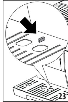
Bevor diese Anzeige aus dem Tassenrost (A12) hervorragt, muss die Abtropfschale entleert und gereinigt werden, andernfalls kann das Wasser über den Rand treten und die Kaffeemaschine, die Aufstellfläche oder den umliegenden Bereich beschädigen.
