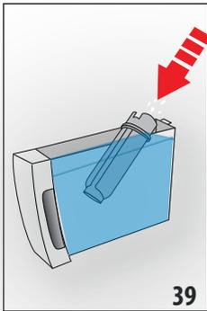
8. „FILTER IN DIE VORRICHTUNG EINSETZEN“: Den Filter (D7) in seine Aufnahme setzen (Abb. 36) und fest nach unten drücken. (Next >) drücken;
