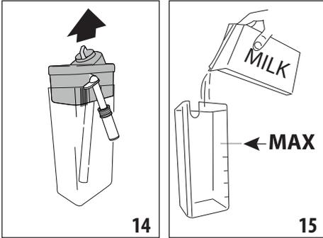
2. Eine ausreichende Menge Milch in den Milchbehälter (E3) füllen, wobei der auf dem Behälter angegebene MAX Füllstand nicht überschritten werden darf (Abb. 15). Dabei ist zu beachten, dass jeder Strich an der Seite des Behälters ca. 100 ml Milch entspricht;
