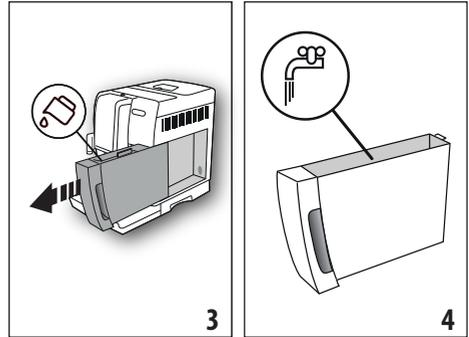
3. Den Wassertank (A17) herausnehmen (Abb. 3), bis zur Markierungslinie MAX (auf dem Tank aufgedruckt) mit frischem Wasser füllen (Abb. 4) und dann einsetzen (Abb. 5);
