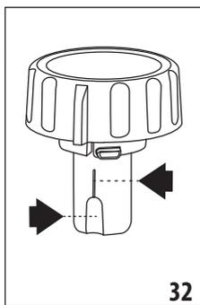
4. Reinigen Sie alle Teile sorgfältig mit Heißwasser und mildem Reinigungsmittel. **Alle Teile können im Geschirrspüler gereinigt werden, allerdings müssen sie auf der oberen Ablage des Geschirrspülers positioniert werden.** Achten Sie besonders darauf, dass an der Aussparung und am Kanal unter dem Drehknopf (Abb. 32) keine Milchrückstände zurückbleiben: schaben Sie den Kanal eventuell mit einem Zahnstocher aus;
