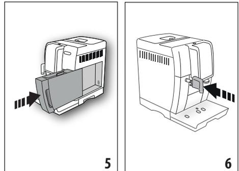
4. Kontrollieren, dass der Heißwasserauslauf (D6) in die Düse (A8) (Abb. 6) eingesetzt ist und einen Behälter (Abb. 7) mit einem Fassungsvermögen von mindestens 100ml darunterstellen;
