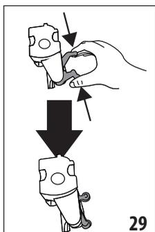
Sollte die Brühgruppe schwer einzusetzen sein, dann muss sie (vor dem Einsetzen) durch Drücken der beiden Hebel, wie auf Abb. 30 gezeigt, in die richtige Größe gebracht werden.
