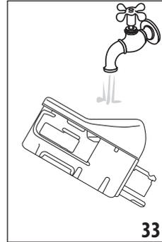
6. Überprüfen Sie ebenfalls, dass das Ansaugrohr und das Ausgaberohr nicht durch Milchrückstände verstopft sind.
