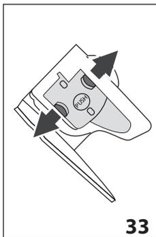
8. Nach dem Einsetzen ist sicherzustellen, dass die beiden farbigen Tasten eingerastet sind und nach außen ragen (Abb. 33).
