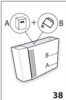
4. „ENTKALKER (FÜLLSTAND A) UND WASSER (FÜLLSTAND B)“ (Abb. 38); den Entkalker bis zum auf der Innenseite des Tanks aufgedruckten Füllstand A (entspricht einer 100ml Packung) in den Wassertank geben; dann bis zum Füllstand B mit Wasser (1l) auffüllen; den Wassertank wieder einsetzen. Den Wahlschalter für „NEXT>“ drücken;
