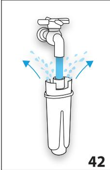
6. „WASSER LAUFEN LASSEN, BIS ES AUSTRITT“ (Abb. 42): Um den Filter zu aktivieren, wie auf der Abbildung gezeigt, Leitungswasser in die Öffnung des Filters laufen lassen, bis das Wasser mindestens eine Minute lang aus den seitlichen Öffnungen austritt. Den Wahlschalter für „NEXT>“ drücken;
