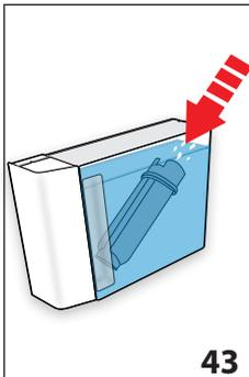
8. „FILTER EINTAUCHEN UND LUFT ENTWEICHEN LASSEN“ (Abb. 43): Den Filter in den Wassertank geben und für etwa zehn Sekunden vollständig eintauchen, dabei neigen und leicht andrücken, um das Entweichen der Luftblasen zu ermöglichen. Den Wahlschalter für „NEXT>“ drücken;
