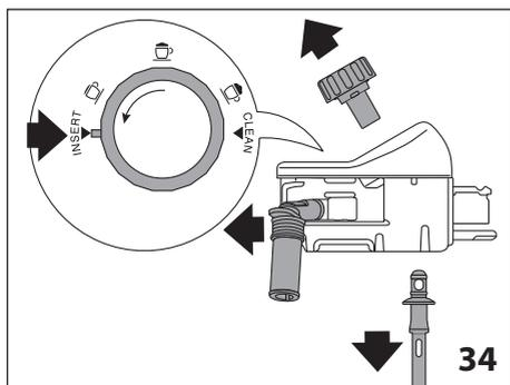
4. Reinigen Sie alle Teile sorgfältig mit Heißwasser und mildem Reinigungsmittel. **Alle Teile können im Geschirrspüler gereinigt werden, allerdings müssen sie auf der oberen Ablage des Geschirrspülers positioniert werden.**
