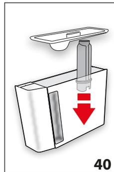
12. (Wenn der Filter installiert war) „FILTER IN DIE VORRICHTUNG EINSETZEN“ (Abb. 40). Den Wahlschalter für „NEXT>“ drücken und den Wassertank entnehmen, den Wasserfilter, falls er zuvor entfernt wurde, wieder einsetzen;
