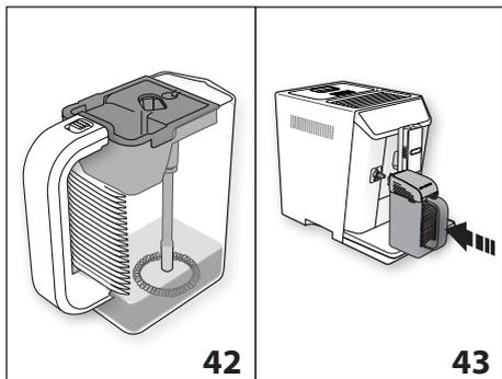
9. "DECKEL SCHLIESSEN UND BEHÄLTER EINSETZEN, FÜR START OK DRÜCKEN" (Abb. 43). Den Behälter (E) entnehmen, den Deckel (E1) wieder schließen und den Behälter fest andrücken und an die Düse andocken (A9). "✓ OK" drücken, um die Funktion zu starten: das Gerät beginnt, Kaffee und Eis zu verrühren und auf dem Display (B) erscheint "CAFFÈ FREDDO" mit einem Balken, der sich mit fortschreitender Zubereitung allmählich füllt.
