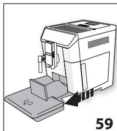
6. "KAFFEESATZBEHÄLTER UND ABTROPFSCHALE LEEREN" (Abb. 59): die Abtropfschale (A14) und den Kaffeesatzbehälter (A10) entnehmen, leeren und wieder einsetzen.
