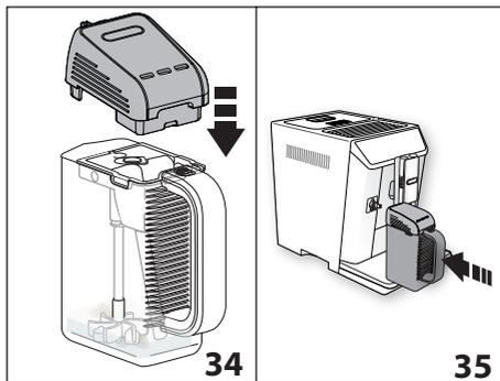
6. "DECKEL SCHLIESSEN UND BEHÄLTER EINSETZEN, FÜR START OK DRÜCKEN": Den Deckel wieder schließen (Abb. 34) und den Behälter fest auf die Düse (A9-Abb. 35) drücken und daran andocken: es ertönt ein akustisches Signal (wenn die Funktion Signalton aktiviert ist).
