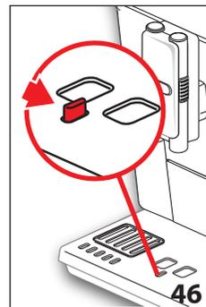
Die Abtropfschale (A14) ist mit einem Schwimmer (A12) (rot) zur Anzeige des Wasserstandes ausgestattet (Abb. 46). Die Abtropfschale leeren und reinigen, bevor diese Anzeige aus dem Tassenrost (A11) hervortritt, andernfalls kann das Wasser über den Rand treten und die Kaffeemaschine, die Aufstellfläche oder den umliegenden Bereich beschädigen.
