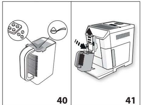
7. "BEHÄLTER UNTER KAFFEEAUSLAUF STELLEN (SCHRITT 5 VON 7)" (Abb. 41): den Kaffeeauslauf (A8) anheben und den Behälter so positionieren, dass der Kaffee direkt in den Behälter (E) ausgegeben wird: "
