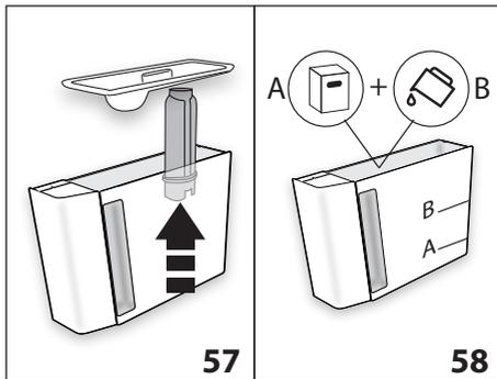
5. "ENTKALKER (FÜLLSTAND A) UND WASSER (FÜLLSTAND B) EINFÜLLEN" (Abb. 58); den Entkalker bis zum auf der Innenseite des Tanks aufgedruckten Füllstand A (entspricht einer 100ml Packung) in den Wassertank geben; dann bis zum Füllstand B mit Wasser (1l) auffüllen; den Wassertank wieder einsetzen.
