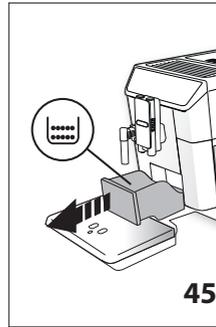
1. Die Abtropfschale (A14) (Abb. 45) herausnehmen, leeren und reinigen.
