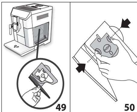
4. Die beiden farbigen Entriegelungstasten nach innen drücken und gleichzeitig die Brühgruppe nach außen herausziehen (Abb. 50).
