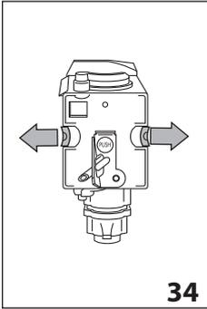
8. Nach dem Einsetzen ist sicherzustellen, dass die beiden farbigen Tasten eingerastet sind und nach außen ragen (Abb. 34).
