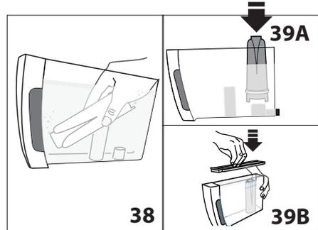
6. Den Filter in seine Aufnahme setzen (Abb. 39A) und fest nach unten drücken;
