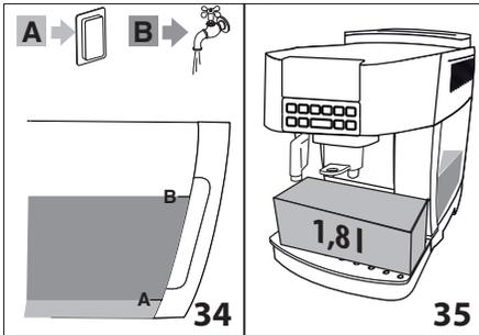
8. Den Entkalker (C3) in den Wassertank füllen, bis der auf der Innenseite des Tanks aufgedruckte Füllstand **A** erreicht ist (entspricht einer 100ml-Packung); dann bis zum Füllstand **B** (Abb. 34) mit Wasser auffüllen (ein Liter) und den Wassertank wieder in die Kaffeemaschine einsetzen;
