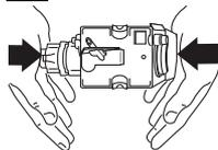
Wenn sich die Brühinheit nur schwer einsetzen lässt, muss diese (vor dem Einsetzen) in die richtige Größe gebracht werden, und zwar indem sie gleichzeitig von unten
