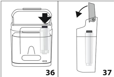
Wenn der Filter eingesetzt wird, muss sein Vorhandensein dem Gerät mitgeteilt werden.
