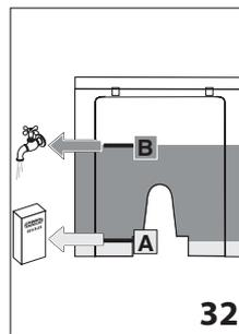
7. Den Entkalker in den Wassertank füllen, bis der auf der Rückseite des Tanks aufgedruckte Füllstand **A** erreicht ist (entspricht einer 100ml-Packung) (Abb. 32); dann bis zum Füllstand **B** (Abb. 32) mit Wasser auffüllen (ein Liter) und den Wassertank wieder einsetzen.
