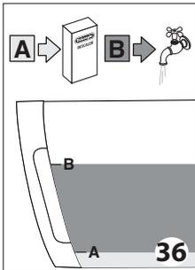
7. Füllen Sie den Entkalker in den Wassertank, bis der auf der Innerseite des Tanks aufgedruckte Füllstand **A** erreicht ist (entspricht einer 100ml-Packung) (Abb. 36); geben Sie dann bis zum Füllstand **B** (Abb. 36) Wasser dazu (ein Liter) und setzen Sie den Wassertank wieder ein.
