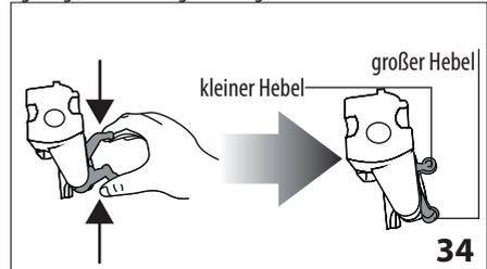
8. Nach erfolgtem Einsetzen der Brühgruppe ist sicherzustellen, dass die beiden roten Tasten eingerastet sind und nach außen ragen (Abb. 35).
