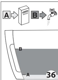
7. Füllen Sie den Entkalker in den Wassertank, bis der auf der Innenseite des Tanks aufgedruckte Füllstand **A** erreicht ist (entspricht einer 100ml-Packung) (Abb. 36); geben Sie dann bis zum Füllstand **B** (Abb. 36) Wasser dazu (ein Liter) und setzen Sie den Wassertank wieder ein.
