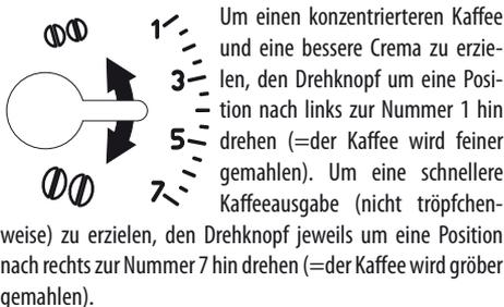
Die Wirkung dieser Einstellung merken Sie lediglich nach der Ausgabe von mindestens 2 Tassen Kaffee. Sollte die Ausgabe noch zu schnell oder zu langsam erfolgen, muss die Korrektur wiederholt werden, indem der Drehknopf um eine weitere Position gedreht wird.
