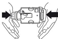
Wenn die Brühinheit sich nur schwer einsetzen lässt, muss diese (vor dem Einsetzen) auf die richtige Größe gebracht werden,
