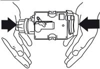
Sollte die Brüheinheit schwer einsetzbar sein, muss diese (vor dem Einsetzen) durch Drücken der beiden Hebel, wie in der Abbildung gezeigt, in die richtige Größe gebracht werden.
