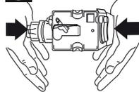
Wenn die Brüheinheit sich nur schwer einsetzen lässt, muss diese (vor dem Einsetzen) auf die richtige Größe gebracht werden, und zwar indem sie gleichzeitig von unten und von oben, wie in der Abbildung dargestellt, fest angedrückt wird.
