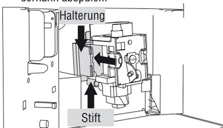
6. Die Brüheinheit nach der Reinigung wieder einsetzen, indem Sie sie an der Halterung und auf dem unten angebrachten Stift einsetzen; dann fest auf die Schrift PUSH drücken, bis das Klicken des Einrastens zu vernehmen ist.
