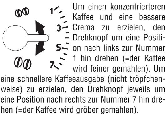
Die Wirkung dieser Einstellung merken Sie lediglich nach der Ausgabe von mindestens 2 Tassen Kaffee. Sollte die Ausgabe noch zu schnell oder zu langsam erfolgen, muss die Korrektur wiederholt werden, indem der Drehknopf um eine weitere Position gedreht wird.
