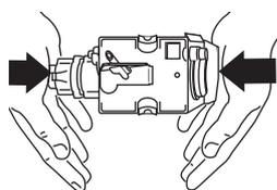
Wenn die Brüheinheit sich nur schwer einsetzen lässt, muss diese (vor dem Einsetzen) auf die richtige Größe gebracht werden, und zwar indem sie gleichzeitig von unten und von oben, wie in der Abbildung dargestellt, fest gedrückt wird.
