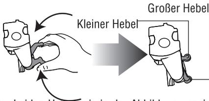
der beiden Hebel, wie in der Abbildung gezeigt, in die richtige Größe gebracht werden.
