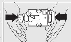
**HINWEIS 3:** Wenn sich die Brüheinheit noch immer schwer einsetzen lässt, versuchen Sie diese nicht mit Gewalt einzusetzen, sondern schließen Sie die Serviceklappe, ziehen Sie den Stecker des Versorgungskabels aus der Steckdose und stecken Sie ihn dann wieder ein. Warten Sie ab, bis das Display sich nach erfolgter Auto-Diagnose ausschaltet, öffnen Sie dann die Serviceklappe und setzen Sie die Brüheinheit wieder ein.
