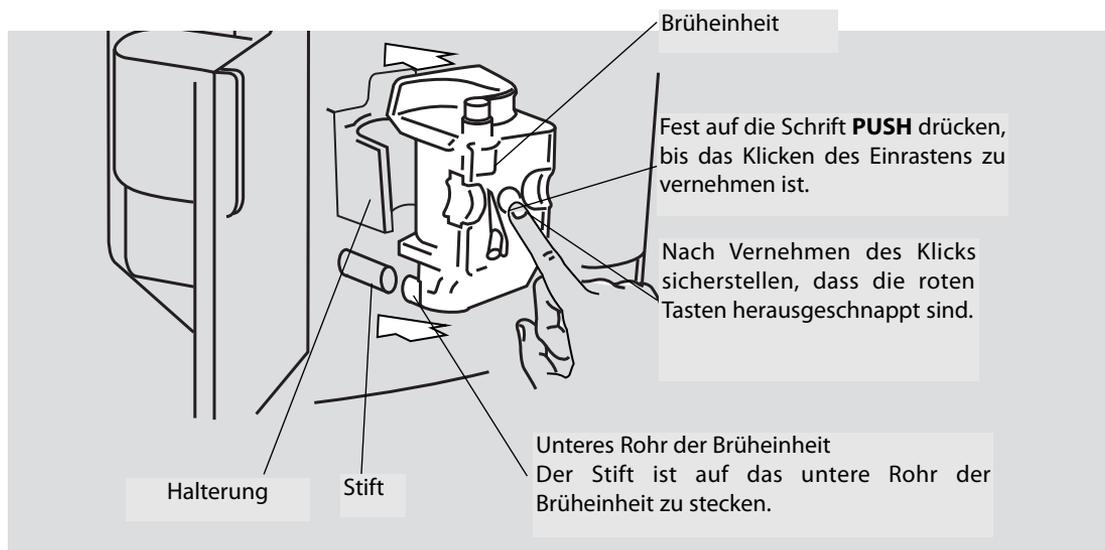
Sicherstellen, dass die beiden roten Tasten herausgeschnappt sind, da sich sonst die Klappe nicht schließen lässt.
