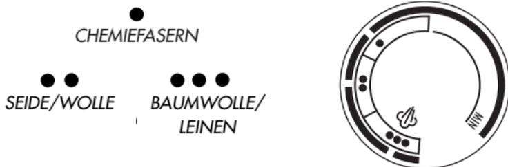
**Denken Sie daran, dass die Funktion Dampfbügeln nur dann eingesetzt werden kann, wenn der Thermostat G auf den Bereich
