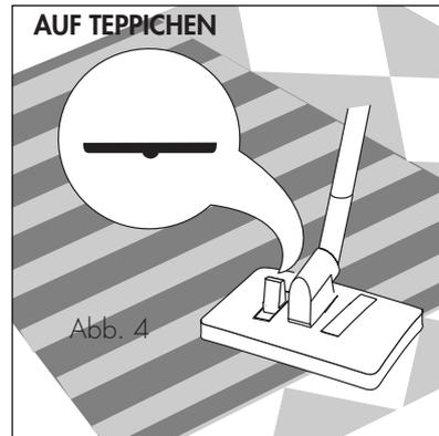
Zur Einstellung der Borstenposition den an der Saugbürste befindlichen Hebel betätigen
