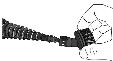
Požadovanou část příslušenství nasuňte vpředu na prodlužovací trubici. Toto lze provést pouze v jednom směru! Dejte pozor na oba konce prodlužovací trubice o rozdílné tloušťce. Ty je nutné zasunout do příslušných otvorů částí příslušenství.
