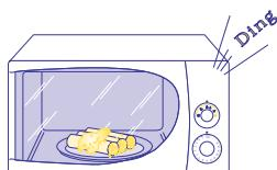
Všechny funkce trouby můžete kdykoli přerušit tím, že otočíte časový spínač do polohy **STOP**. Můžete také přímo za chodu změnit čas přípravy jídla tak, že otočíte časovým spínačem vpřed nebo vzad. Během přípravy jídla můžete zkontrolovat průběh vaření tak, že otevřete dvírka a na jídlo se podíváte. Tím přerušíte funkci trouby, ale jakmile dvírka zase zavřete, trouba se znova rozbehne.
