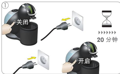
① 关闭机器。检查胶囊是否被堵塞（请参阅第10页）。拔出电源插头并等待20分钟。然后将电源插头插入电源插座，并开启机器。
