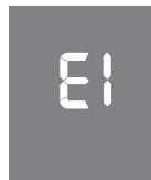
"Probe Failure"<br>(повредена термосонда)                                                                                                 |
