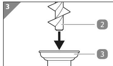
7. Richten Sie die Transportschnecke **2** durch leichtes Drehen zum Haltestift **6** aus.
