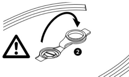
Dévissez le bouchon de la chaudière en utilisant une pièce de monnaie et videz l'eau restante. Ajoutez une tasse d'eau du robinet ou de l'eau filtrée et secouez l'appareil puis videz toute l'eau. Répétez cette opération jusqu'à ce que l'eau de la chaudière sorte transparente et propre.
