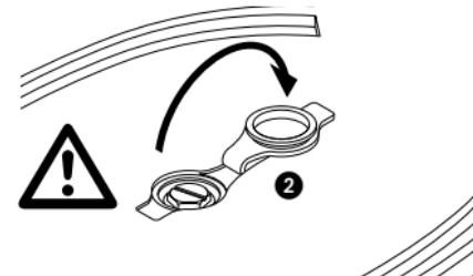
Ruuvaat hörykattilan korkki auki kolikolla ja tyhjennä mahdollinen vesi. Lisää kupillinen vesijohtovettä tai suodatettua vettä. Ravistele laitetta ja tyhjennä kaikki vesi. Toista toiminto, kunnes hörykattilasta tuleva vesi on kirkasta ja puhdasta.
