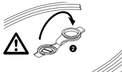
Pomocí mince odšroubujte krytku bojleru a vylijte veškerou vodu. Přidejte jeden šálek vody z vodovodní sítě nebo filtrované vody, protřepete přístroj, a pak vodu vylijte. Tuto operaci opakujte, dokud z bojleru nebude vycházet čistá a čirá voda.
