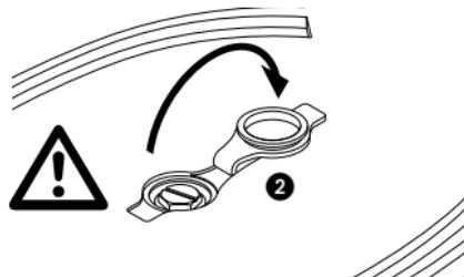
Desenrosque o tampão da caldeira, utilizando uma moeda, e despeje toda a água que reste no depósito. Adicione uma chávena de água da torneira ou filtrada, abane o aparelho e depois despeje a água toda.
