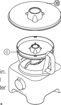
1 Setzen Sie Antriebswelle und Schüssel auf die Antriebseinheit.
