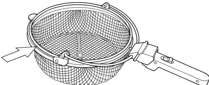
Si raccomanda di pulire regolarmente il cestello avendo cura di eliminare tutti gli eventuali depositi che possono essersi accumulati nell'anello guida ruota dello stesso.
