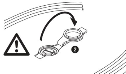
Desenrosque o tampão da caldeira, utilizando uma moeda, e despeje toda a água que reste no depósito. Adicione uma chávena de água da torneira ou filtrada, abane o aparelho e depois despeje a água toda.
