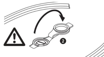
Odkręcić zatyczkę podgrzewacza przy użyciu monety i opróżnić ewentualne pozostałości wody. Dodać jedną szklankę wody kranowej lub przefiltrowanej i wstrząsnąć urządzenie, a następnie wylać całą wodę. Powtarzać tę czynność, aż woda wylewana ze zbiornika będzie czysta. Po zakończeniu czyszczenia nalać 500 ml świeżej wody kranowej lub przefiltrowanej do podgrzewacza i zatknąć zatyczką podgrzewacza bez użycia nadmiernej siły. Założyć z powrotem pokrywę. Urządzenie jest gotowe do użytku.
