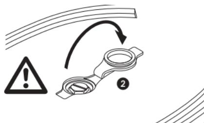
Bozuk madeni bir para kullanarak su kaynatma haznesinin kapağını çevirerek çıkarınız ve içindeki suyu boşaltınız. İçine bir kap ya da filtre edilmiş su koyunuz ve çalkaladıktan sonra suyu dökünüz. Su, Hazneden temiz ve berrak olarak çıkışına kadar işleme devam ediniz.
