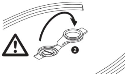
Skru hætten til varmtvandsbeholderen af med en mønt og tøm eventuelt vand af. Tilsæt en kop vand fra hanen eller filtreret vand og ryst apparatet. Tøm derefter alt vand ud. Gentag denne operation, til vandet fra varmtvandsbeholderen er klart og rent, når det kommer ud. Efter rengøringen hældes 500 ml friskt vand fra hanen eller filtreret vand i varmtvandsbeholderen, og hætten til varmtvandsbeholderen skrues på igen uden at anvende for stor kraft. Sæt låget på igen. Nu er enheden klar til brug.
