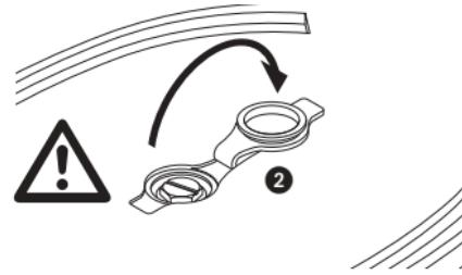
Odvijte pokrovček kotlička s kovancem in zlijte ven vodo. Doličte približno za kozarec vode, pretresite napravo in spraznite. To ponovite, dokler iz kotlička ne priteče čista voda.
