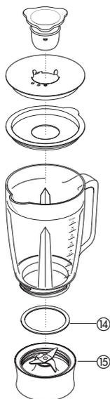
**Nota: A base do moinho não pode ser trocada pelo jarro liquidificador de vidro FP920/FP930. O aparelho não funciona se for colocada a base errada. Consulte o gráfico quanto às bases da unidade das lâminas.**
