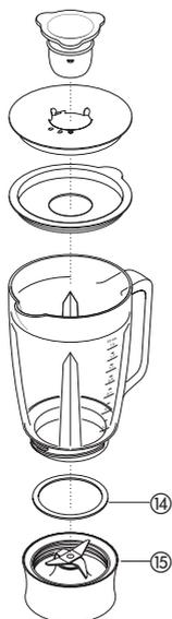
**Nota: la base del molinillo no es intercambiable con la jarra licuadora de vidrio FP920/FP930. El procesador no funciona si se pone la base incorrecta. Consulte los gráficos de las bases de las unidades de cuchillas.**
