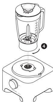
Dikkat: Öğütücü tabanı, FP925 cam karıştırıcı haznesi ile değiştirilerek kullanılamaz. Yanlış taban oturtulduğu takdirde, mutfaık robotu çalışmaz. Bıçak ünitesinin tabanındaki şekillere bakın.
