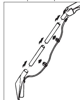
Συνδέστε το σωληνάκι παροχής στη λαβή του εύκαμπτου σωλήνα στερεώνοντάς το καλά μέχρι να ασφαλίσει το πλήκτρο μπλοκαρίσματος-ξεμπλοκαρίσματος (εικ. I).
