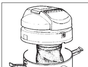
Εφοδιάστε τον πλωτήρα του μοτέρ (15) με το χάρτινο φίλτρο (36). Στερεώστε το χάρτινο φίλτρο με το ειδικό δαχτυλίδι στερεώσης του σάκου (40) ή με ένα συνηθισμένο λαστιχάκι (εικ. C). Τοποθετήστε τη σακούλα περισυλλογής σκόνης (37) στο εσωτερικό του κάδου περνώντας το χάρτινο κολαρό γύρω από το στόμιο αναρρόφησης (εικ. D).
