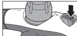
4. Richten Sie die Düse auf das Objekt, das Sie mit Dampf reinigen möchten, und drücken Sie den Dampfschalter.
