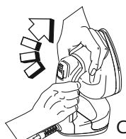
C Tournez la semelle dans le sens horaire à l'aide de la poignée spécifique.
