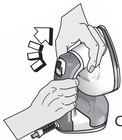
C Gire la plancha en sentido horario mediante la manivela
