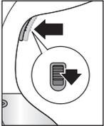
Um dauerhaft Dampf auszustößen, können Sie die Dampfstoß-taste auch arretieren.
