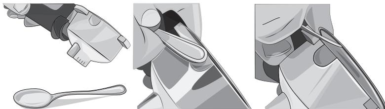
**ΣΗΜΕΙΩΣΗ:** Η υποδοχή φίλτρου προμηθεύεται με ήδη τοποθετημένο το φίλτρο για 2 φλυτζάνια. Για να δείτε πως αφαιρείται το πλήκτρο, συμβουλευθείτε τις εικόνες. Μπορείτε να αφαιρέσετε το φίλτρο ανασηκώνοντάς το με τα δάκτυλα.
