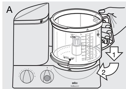
Następnie przekręcić pojemnik w kierunku strzałki «function» aż do oporu.
