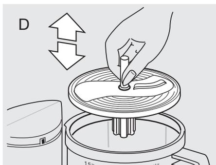
skal bearbeides i påfyllingsrøret mens motoren er slått av. Ved ytterligere påfylling skal motoren være slått av.
