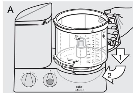
2. Встановіть необхідне пристосування (див. інструкцію для кожного пристосування) на приводний вал ємності та
