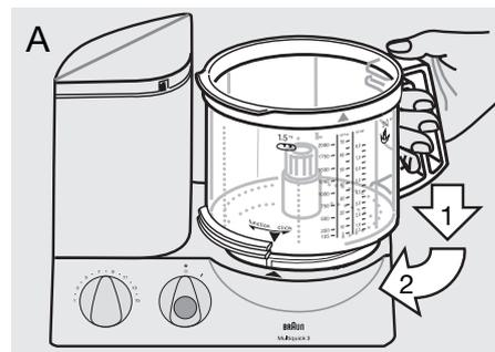
находится на моторном блоке (A). После этого поверните емкость в направлении «function» вращения оси привода до предельного положения.
