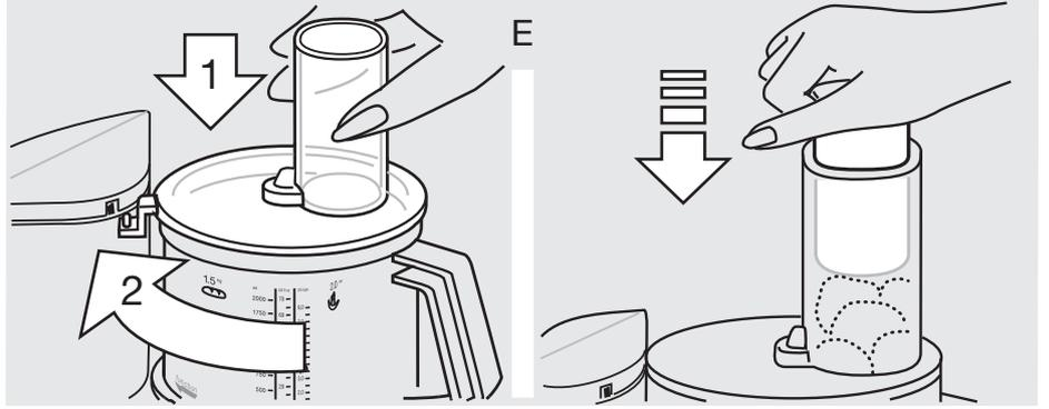
كما يجب أن يكون المحرك مطفأً عند إعادة التعبئة أيضاً. احذر أن تمد يدك داخل أنبوب التعبئة أثناء تشغيل المحرك، وحرص دائماً على استعمال الحشاية ⑧ (الشكل E).
