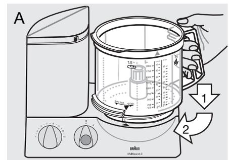
Drehen Sie dann die Universalschüssel in Pfeilrichtung «function» bis zum Anschlag.
