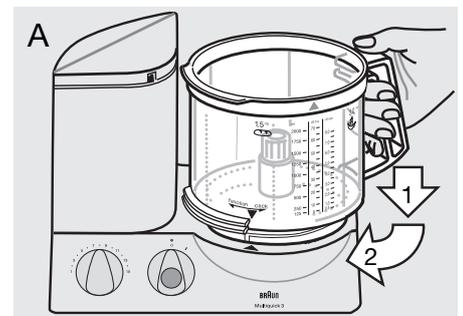
2. Τοποθετήστε το εξάρτημα που χρειάζεστε (δείτε τις οδηγίες για κάθε εξάρτημα ξεχωριστά) στον οδηγό του μπολ, αυτή τη φορά και πιέστε το προς τα κάτω να σταθεροποιηθεί.
