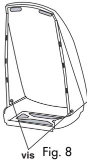
Fixer l'ensemble avec les vis précédemment retirées. Introduire la bouteille de gaz dans l'espace prévu (fig.8).
